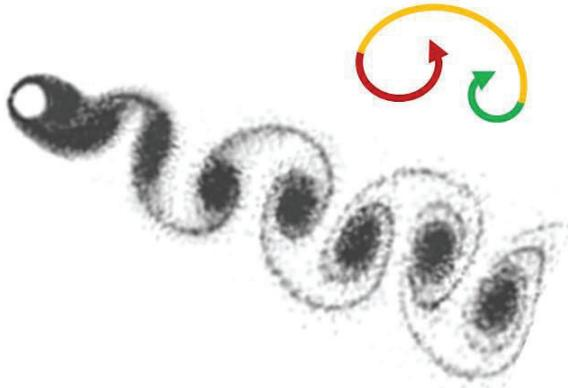
Abb.3: Der Nachlauf einer Störung in der Strömung. Die Karman'sche Wirbelstraße und ein signifikantes Teilelement dieser.
