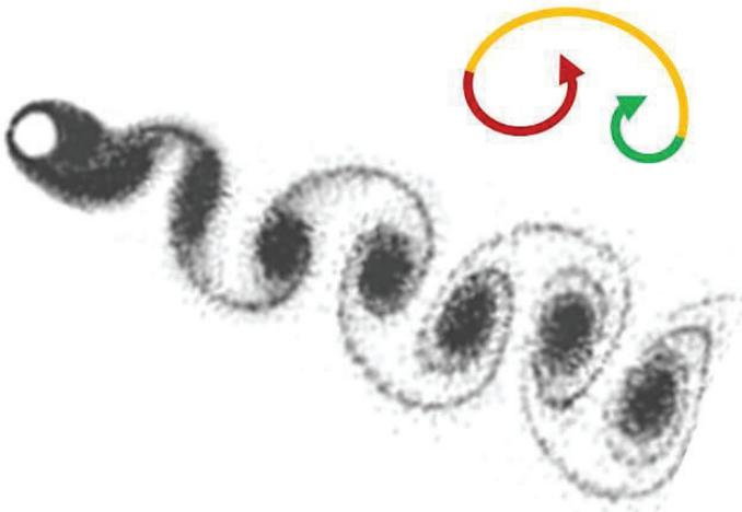
Abb.3: Der Nachlauf einer Störung in der Strömung. Die Karman'sche Wirbelstraße und ein signifikantes Teilelement dieser.
